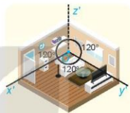
Một mô hình phòng khách được biểu diễn bằng hình chiếu trục đo
