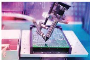
b) Bản mạch được in 3D
