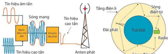
Hình 4.10. Quá trình phát sóng radio AM và việc thu tín hiệu khi đài phát ở xa máy thu
