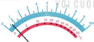
Hình 8.9. Thang chia độ tuyến tính và phi tuyến: thang màu xanh ứng với trường hợp tuyến tính; thang màu đỏ ứng với trường hợp phi tuyến
