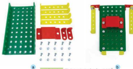
Hình 3 Thân robot và các chi tiết
