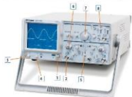
▲ Hình 1.4. Mặt trước của dao động kì
