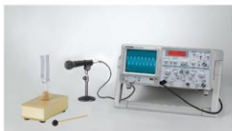
▲ Hình 13.4. Bối trí thí nghiệm quan sát đồ thị dao động âm
