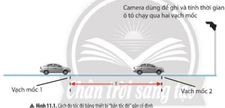
▲ Hình 11.1. Cách đo tốc độ bằng thiết bị “bắn tốc độ” gắn cố định
