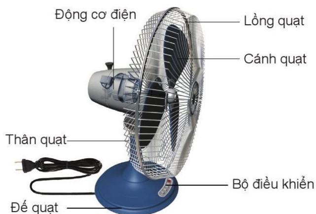
Hình 14.2. Cấu tạo của quạt điện
