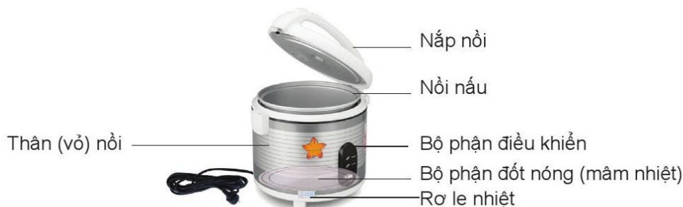
Hình 13.2. Cấu tạo của nồi cơm điện
