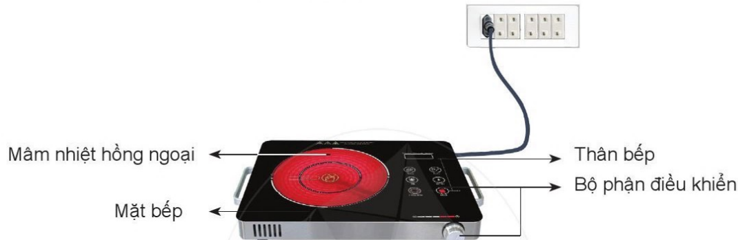
Hình 13.4. Cấu tạo của bếp hồng ngoại
