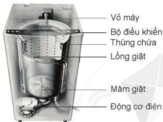
Hình 14.5. Cấu tạo của máy giặt
